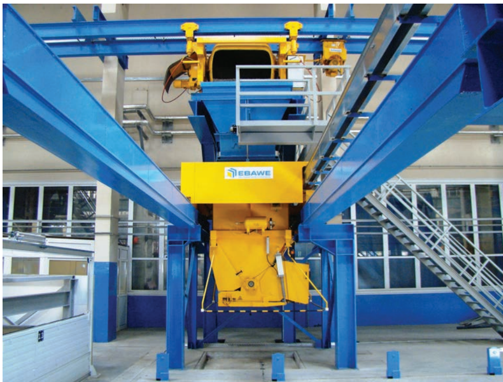
Автоматическое заполнение бетонораздатчика при помощи новой линии автоматической подачи бетона фирмы Kibat
