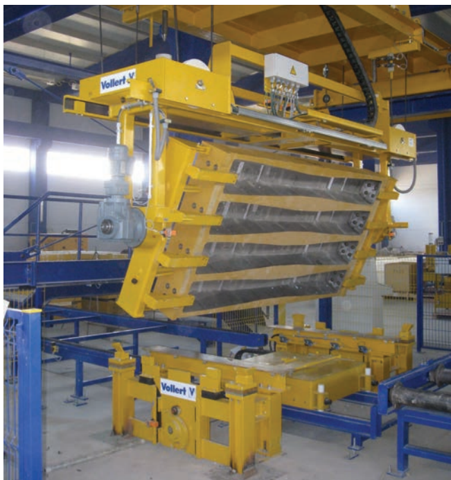
При помощи переворотного устройства формы поворачиваются на 180 градусов для выгрузки шпал
