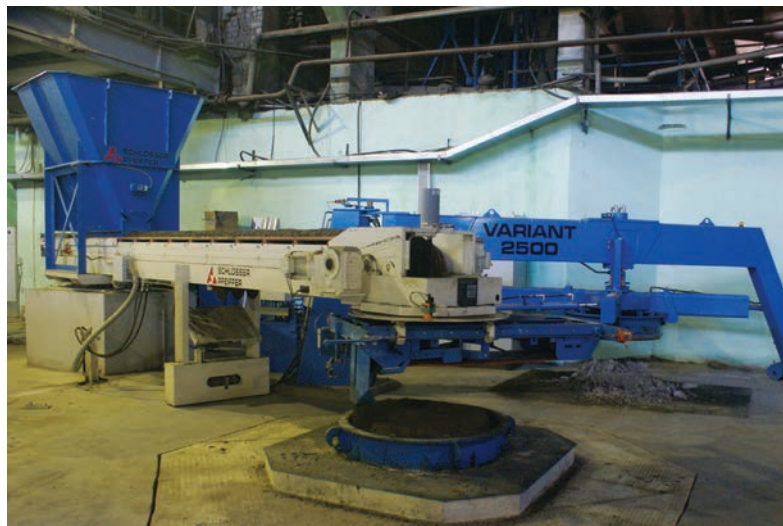
Установки «Вариант», соединяющие в себе лучшие качества вибрационной техники Schlosser Pfeiffer, позволяют организовать производство бетонных труб, колец и тюрбингов диаметром от 300 до 6000 мм.
