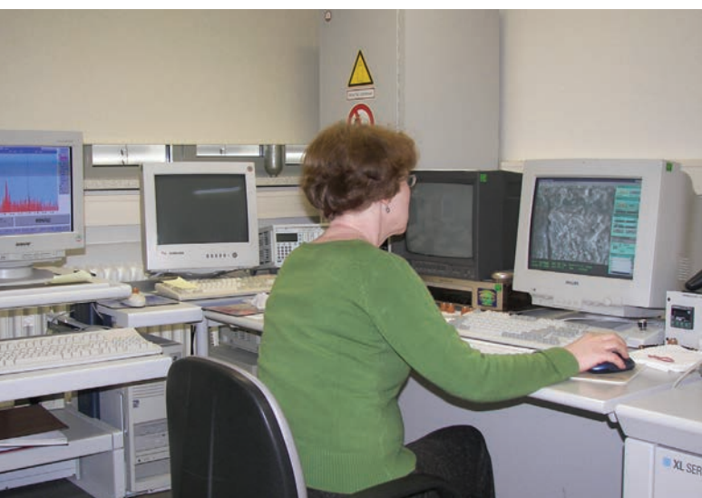
Исследование микроструктуры и химического состава бетона при помощи растровой электронной микроскопии (РЭМ) и детектора рентгеновского излучения
