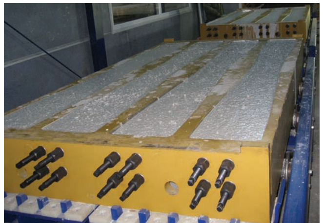
Форма для шпал после процесса бетонирования
