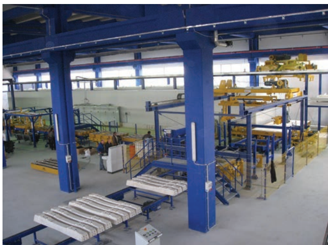
Подача выгруженных шпал на участок монтажа креплений для рельсов
