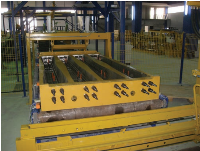
Форма для шпал после установки арматуры
